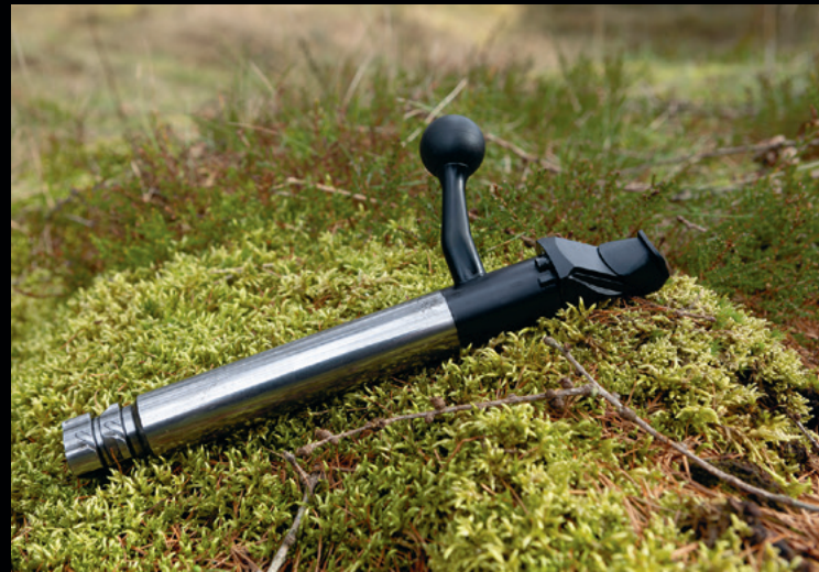
Låsen er af stål og lavet i et stykke uden udskifteligt bundstykkehoved.
